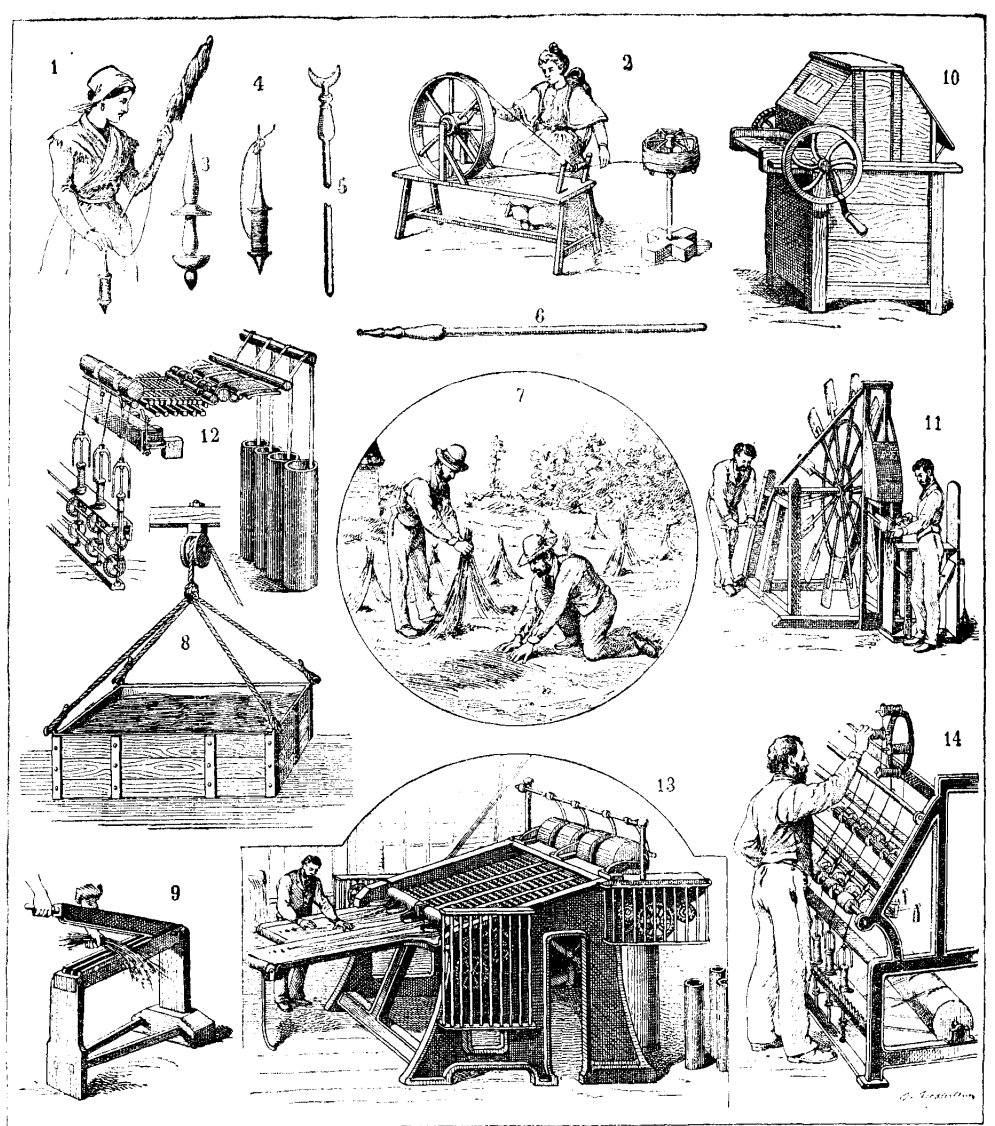
LIN : 1. Fileuse à la quenouille ; 2. Au rouet. — 3 et 4. Fuseaux. — 5 et 6. Quenouilles. — 7. Rouissage en prairie ; 8. En caisson. — 9. Broie à main. — 10. Effilocheuse. — 11. Teillage. — 12. Bauc à broches. — 13. Étaleuse. — 14. Métier à filer le lin à sec.
