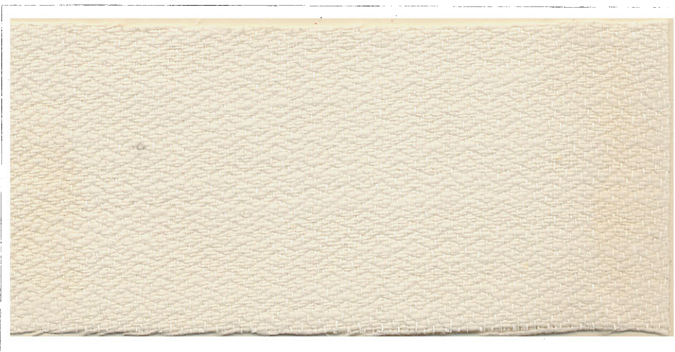
Mit Hilfe der Schaftmaschine hergestelltes Kreppgewebe.
