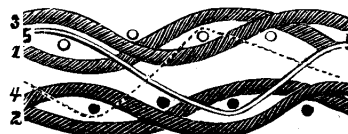
Fig. 1474. Querschnitt einer zweifachen Ware mit Verbindeschüssen. (Zu Fig. 1473.)
