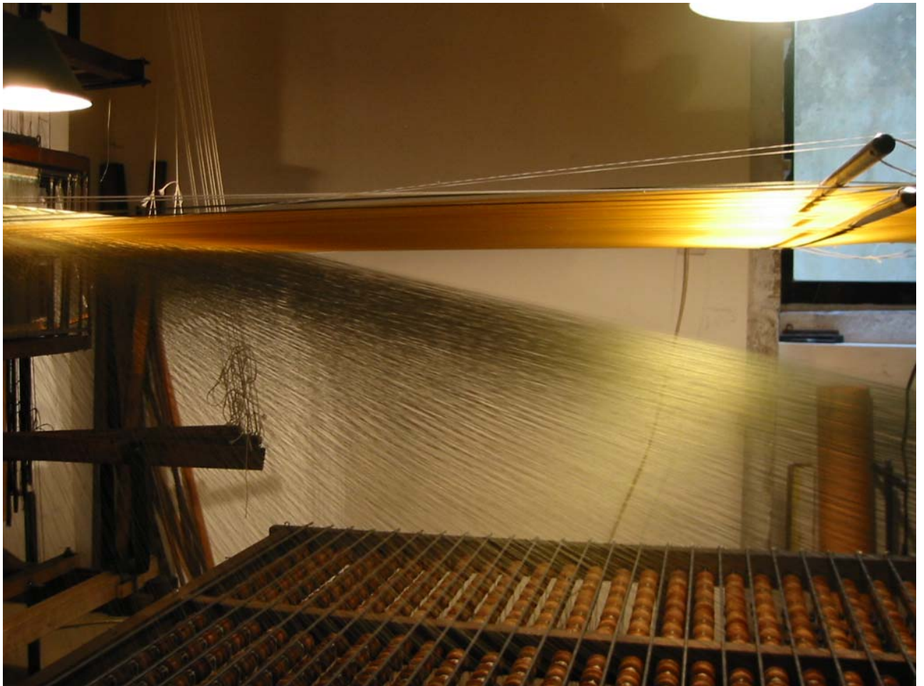
Les fils poil remontent de la cantre à velours - Atelier du Chelu – France
